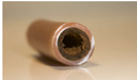
Versprödetes und verschlammtes Bodenheizungsrohr.
