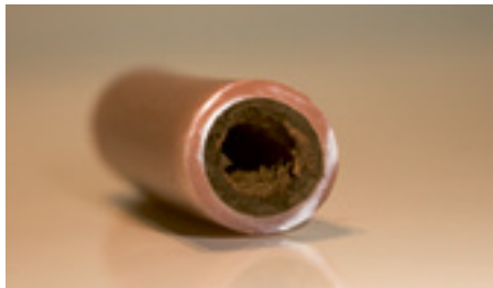
Versprödetes und verschlammtes Bodenheizungsrohr.
